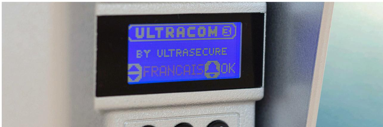
Même avec un fort ensoleillement, l'information affichée à l'écran reste parfaitement accessible. C'est là, et lors des nuits les plus sombres, que le **rétroéclairage puissant** s'avère des plus pratique. L'écran n'aura pas d'impact significatif sur l'autonomie de la platine, grâce au **détecteur de mouvement** inclus à la platine, qui se chargera d'allumer l'écran uniquement **lorsqu'une personne se présente** à elle (*3 sensibilités de détection possibles*).
